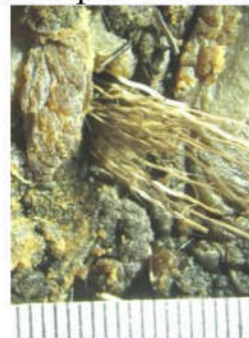
Рис. 5. Вид повреждений после применения раствора Ратневского А.Н.
